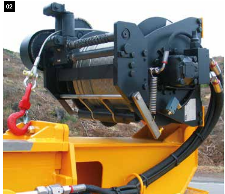
01 Schlittenplatte mit KH 10SF seitlich verschiebbar // side shift slide with KH 10SF 02 Seilkernwinde // Wire-line winch
