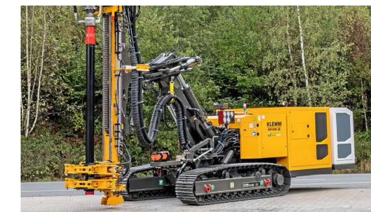
Äußerlich unterscheidet nur der weiß lackierte Akkupack die E-Version von der Diesel-Variante.
